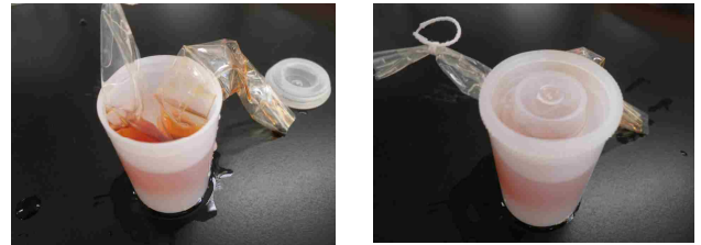
図1 フィルムケースに透析チューブを入れたところ
