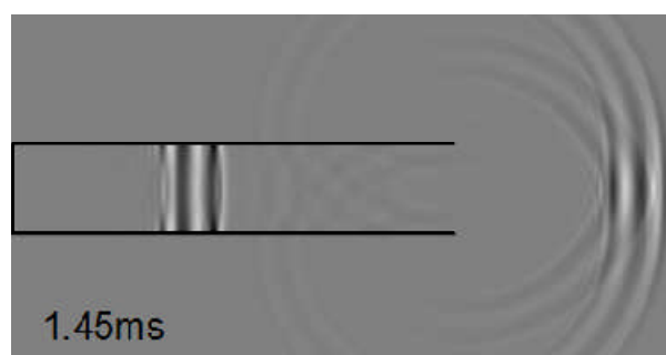
図2 管（長さ：500mm，内径：100mm，左端：閉口，右端：開口）内の気柱中央断面から発生・伝播する音波の可視化画像 ※ 各画像中の時間は音波発生からの経過時間
