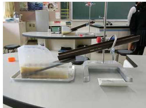
図8 堆積実験の装置
