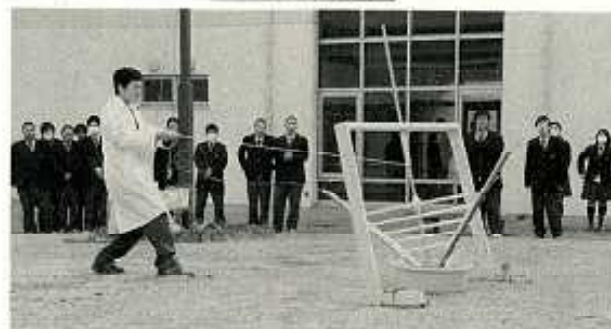
遠心力で水をくみ上げ噴水を発生させる実験の様子=徳所市の青翔高校
