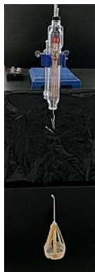
図1 髪の毛の弾性測定装置
