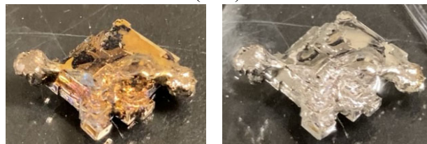
図3 (左)塩酸で酸化被膜を溶かす前のビスマス (右)塩酸で酸化被膜を溶かした後のビスマス
