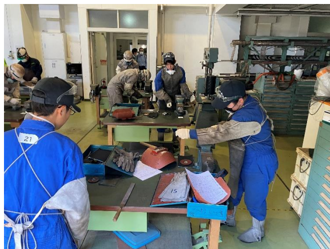
15分間の開先加工!溶接材料を整えます!
