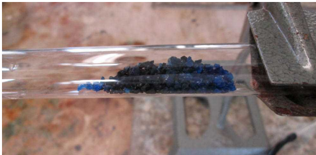
図4 反応終盤シリカゲルが黒くなる
