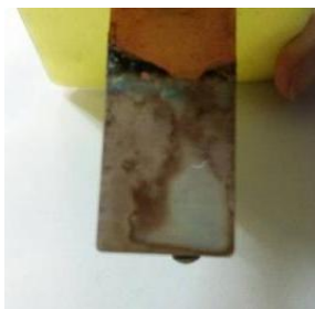
[図10] 陽極板に付着した CuClの白い膜
