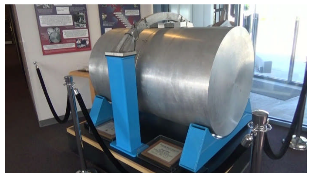
図2 ウェーバーが使用した共振型観測装置
