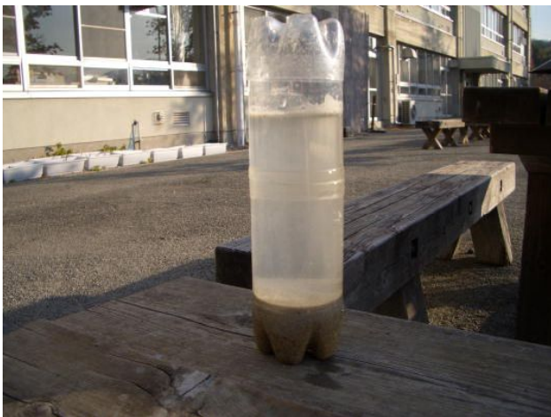
図6 簡易型沈降実験装置
