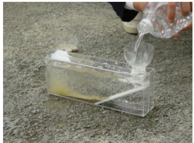
図7 簡易型堆積実験装置
