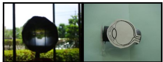
図2 凸レンズを用いた眼球モデル
