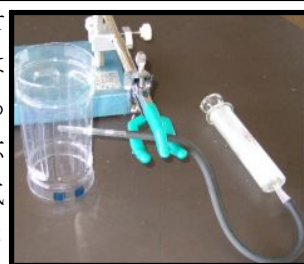
図5 気体の重さ確認教材
