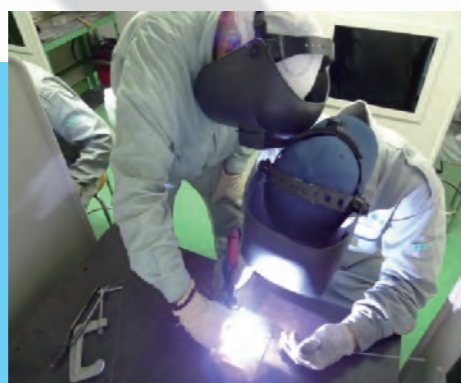
約 5500℃の熱で溶かします
