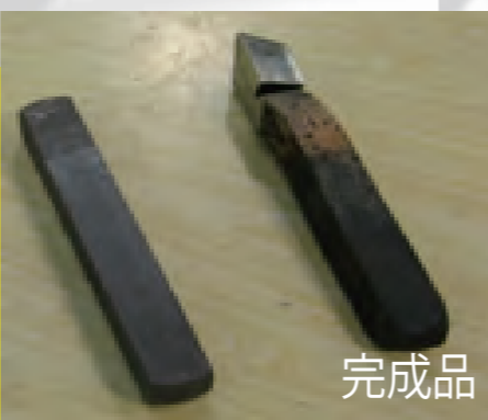
鉄を削る刃物を、鍛造で 製作します
