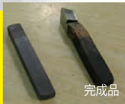
鉄を削る刃物を、鍛造で製作します
