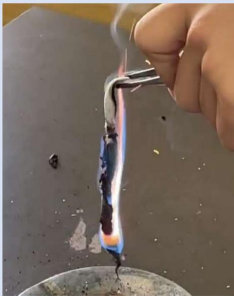
薬品の配合はいろいろ試した結果、文献通りC粉末:KNO<sub>3</sub>:S粉末=1:2:1が最適であった。◇酸素供給剤として硝酸カリウムKNO<sub>3</sub>に替えて塩素酸カリウムKClO<sub>3</sub>を用いてもこの比は同様。しかし、KClO<sub>3</sub>では燃焼が激しすぎ、私たちが作ろうとする花火には不適と判断した。◇紙素材の選定だが、市販品の線香花火に一番近いのはバラ作成用紙であったが、薬包紙が強度、縷り合わせやすさ等の点で一番適していた(大きさに難あり)。
